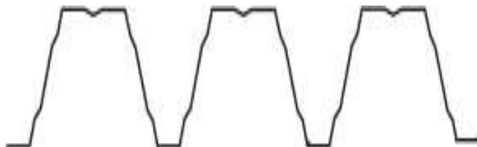
1. ábra. Magashullámú trapézlemez jellemző keresztmetszete
