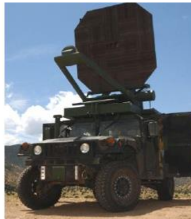
4. ábra. ADS technológia elemei és ADS HMMWV hordozón [15] [16]
