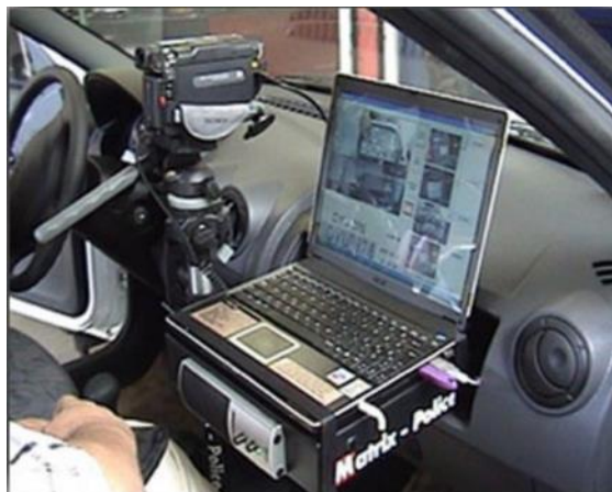
7. ábra. Gépjárműben elhelyezett rendszám-azonosító berendezés [12]
