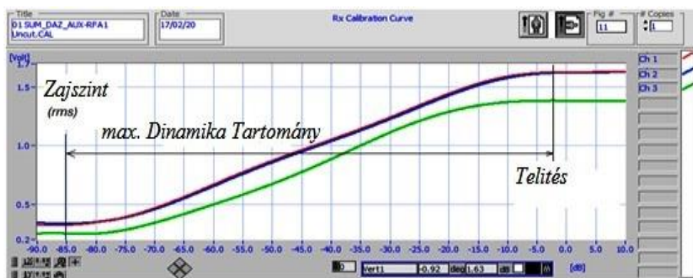
3. ábra: Hibás vevőrendszer-linearitás (forrás: szerző)
