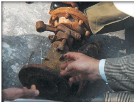
3. kép. A klórkiáramlás megszüntetésére legyártott „kitörés gátló”
