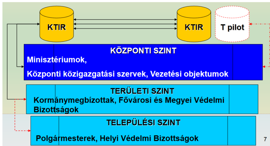
4. ábra. A KTIR hálózat felépítése, információs kapcsolata [15]
