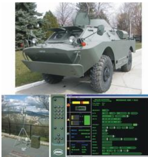
5. ábra. Járműfedélzeti ABV felderítő rendszer [57]
