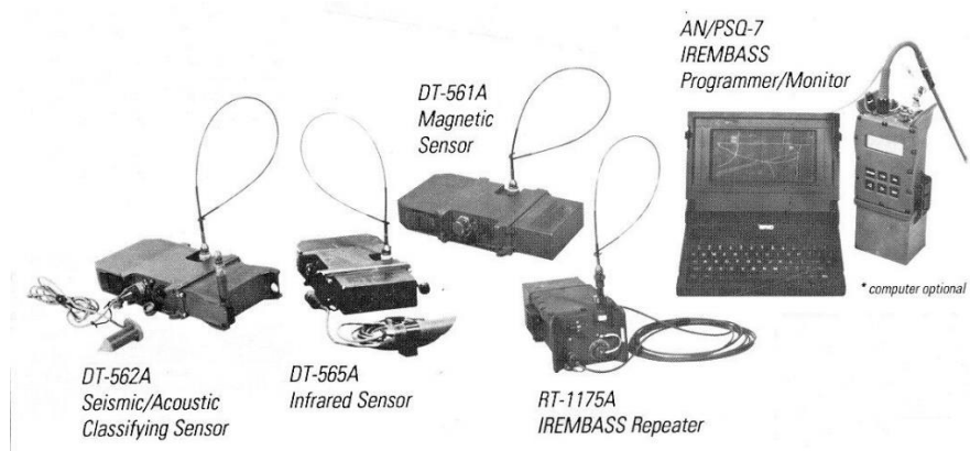
4. ábra A REMBASS rendszer alkotóelemei [23]
