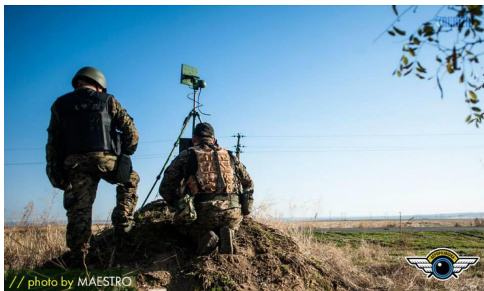
5. ábra Nagy nyereségű, irányított mikrohullámú patch antenna a földi szegmens oldalán Hiba! A hivatkozási forrás nem található.
