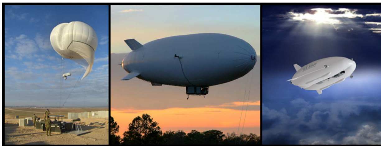
7. ábra. Levegőnél könnyebb UAV típusok Balról jobbra: SkyStar 300 15 , Polar 400 16 , LEMV 17
