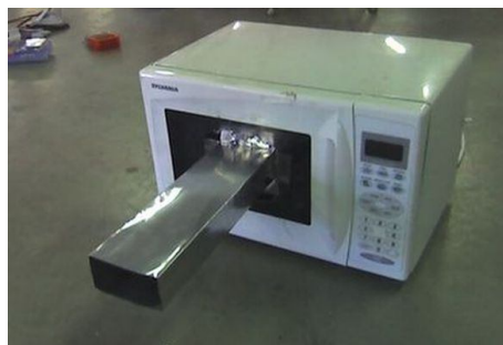
1. ábra. EMP mikrohullámú sütőből (forrás: www.fegyverlabor.hu )
