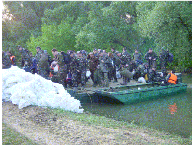
2. sz. kép: Rohamcsónakból és pontonokból összeszerelt Katamarán-szerű jármű (Képet készítette: Török László mk. alez.)
