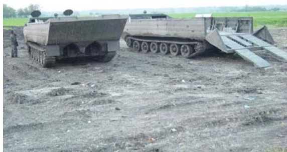
1. sz. kép: PTSZ-M közepes lánctalpas úszó jármű (Képeket készítette: Török László mk. alez.)
