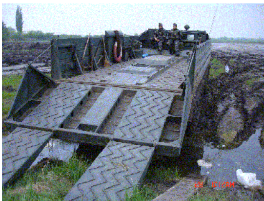
1. sz. kép: PTSZ-M közepes lánctalpas úszó jármű (Képeket készítette: Török László mk. alez.)
