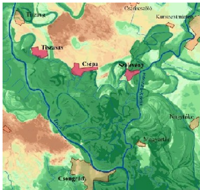
5. sz. kép: FÖMI-től kapott domborzatmodell alapján készült elöntés modell (Vízügyi Központ és Közgyűjtemények, Budapest)
