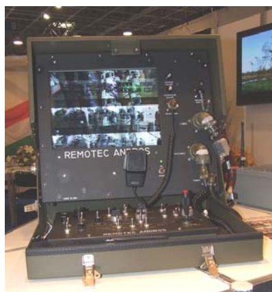
4. ábra 14 : Az ANDROS F-6A nehéz tűzszerezés robot vezérlő egysége
