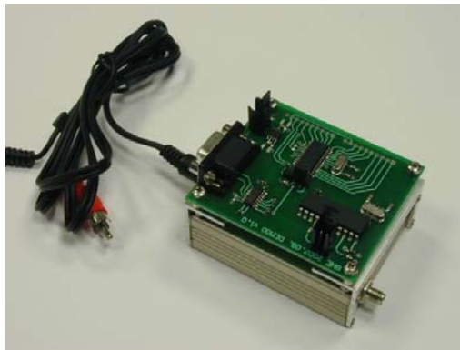
2. kép, a demodulátor egység és a hozzá kapcsolt RF vevő
