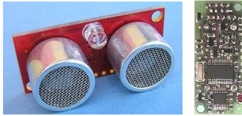
5. ábra. SRF08 ultrahangos távolságmérő modul
